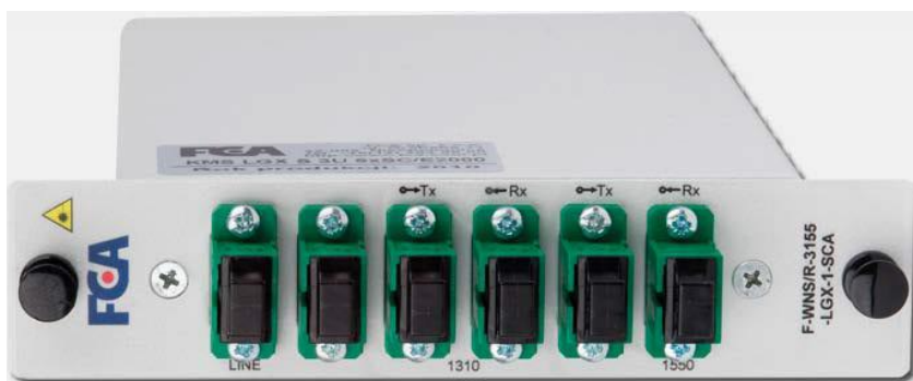
Układ dwóch cyrkulatorów F w obudowie LGX
