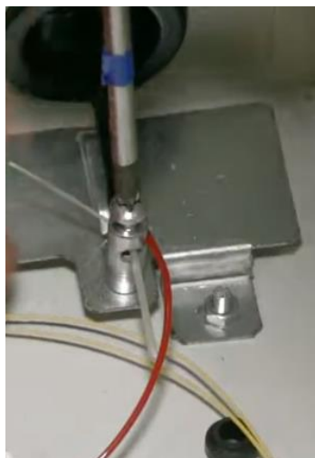
Fot.3 Mocowanie uchwyty wytrzymałościowego
